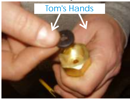
Install washer in Co2 fitting (CGA320)
